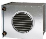
Mit einem im Zuluftkanal montierten Luftkühler wird in der Wohnung eine Komfortkühlung erzeugt, indem ein Kälteträgerkreis oder Kühlwassernetz mit dem Kühler verbunden wird. Der Luftkühler wird automatisch über das Smart-Steuersystem des Lüftungsgeräts gesteuert und die Einstellungen lassen sich mithilfe einer CASA Smart-Bedieneinheit anpassen. Lieferumfang: Luftkühler, SET-Anschlussmodul, Stellantrieb und Dreiwegeventil, 24-V-Transformator, erforderliche Fühler und Anleitung.
