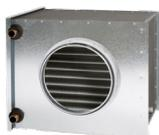
In Gebäuden mit wasserbasierter Heizungsanlage kann die Zuluft mit einem wasserbasierten kanalmontierten Lufterhitzer erwärmt werden. Der Lufterhitzer wird automatisch über das Smart-Steuersystem des Lüftungsgeräts gesteuert und die Einstellungen lassen sich mithilfe einer CASA Smart-Bedieneinheit anpassen. Lieferumfang: Lufterhitzer, SET-Anschlussmodul, Stellantrieb und Dreiwegeventil, 24-V-Transformator, erforderliche Sensoren und Anweisungen.
