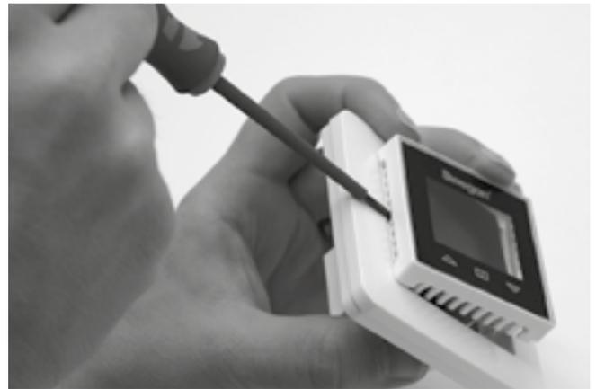
Werden mehrere Bedieneinheiten in Reihe geschaltet, muss der Busabschluss der mittleren Einheit in die geöffnete Stellung („Open“) gebracht werden. Wird nur eine Bedieneinheit genutzt, müssen die Steckbrücken nicht umgesetzt werden.
