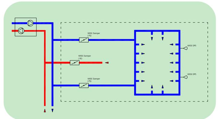
Diagrama básico de circuitos, grupo de regulación de presión constante en sistemas de conductos circulares
