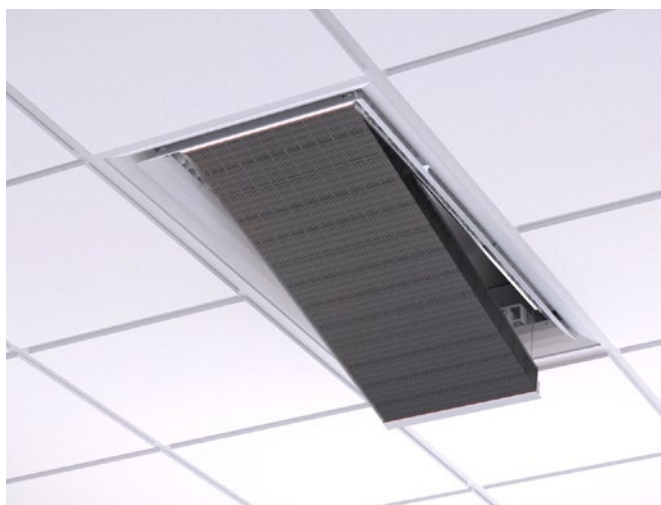
Figur 12. Demontering av underplåt samt fällning av batteri för noggrann rengöring vid höga hygienkrav. Obs! kräver att produkten beställs med tillbehöret, fällbart batteri, samt att flexibla anslutningsslangar används på vattensidan.
