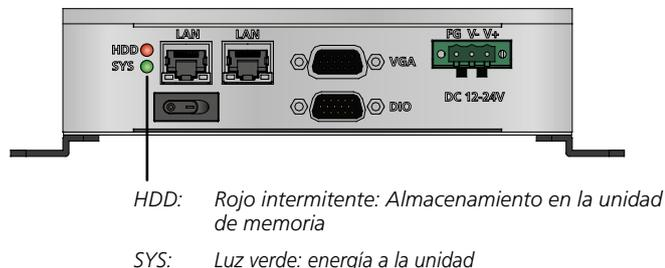
Figura 7. Explicación de los LED de la unidad de control SuperWISE II.
