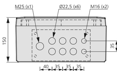
Figure 10. SuperWISE II, SuperWISE II SC face inférieure, cotes (en mm).
