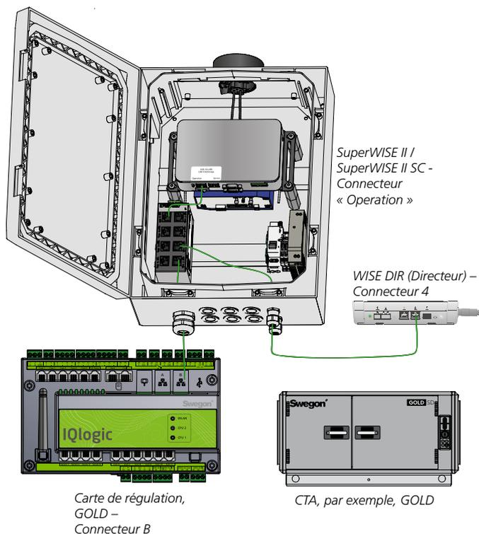
Figure 4. Connexion du réseau, SuperWISE II, SuperWISE II SC.
