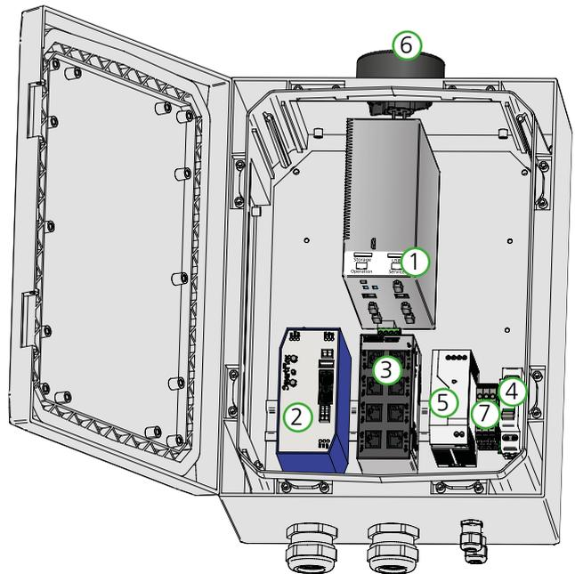
Figure 2. SuperWISE II 2K, SuperWISE II 2K SC. REMARQUE: Swegon Connect (2) et l'antenne (6) sont uniquement inclus dans SuperWISE II 2K SC.
