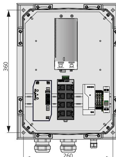
Figure 9. Trous d'installation (mm), SuperWISE II 2K, SuperWISE II 2K SC. 4x vis de fixation (Ø trou = 8 mm), sélection des vis en fonction du matériau du support.
