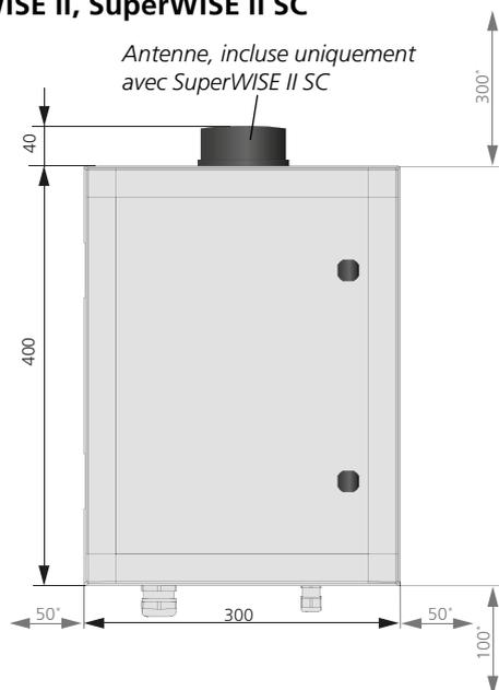
Figure 6. SuperWISE II, SuperWISE II SC, cotes (en mm).
