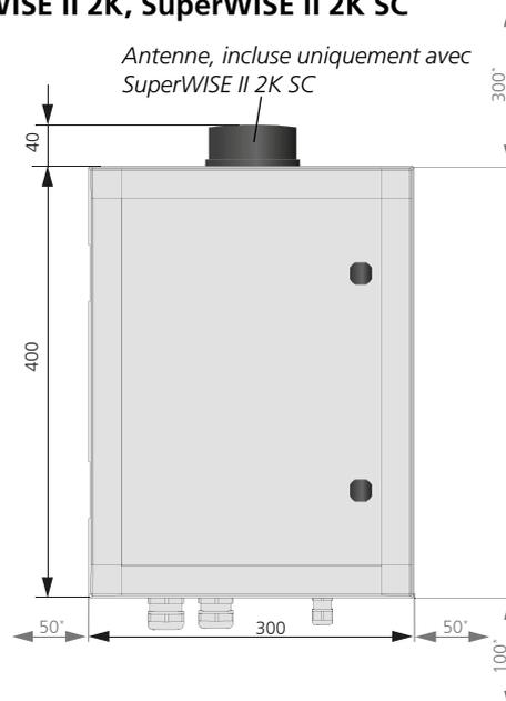
Figure 7. SuperWISE II 2K, SuperWISE II 2K SC, cotes (en mm).
