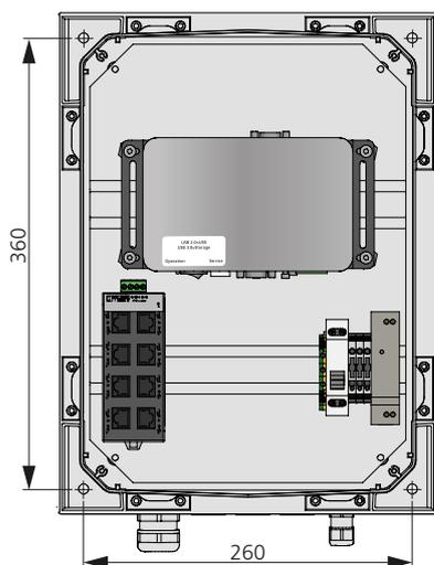
Figure 8. Trous d'installation (mm), SuperWISE II, SuperWISE II SC. 4x vis de fixation (Ø trou = 8 mm), sélection des vis en fonction du matériau du support.
