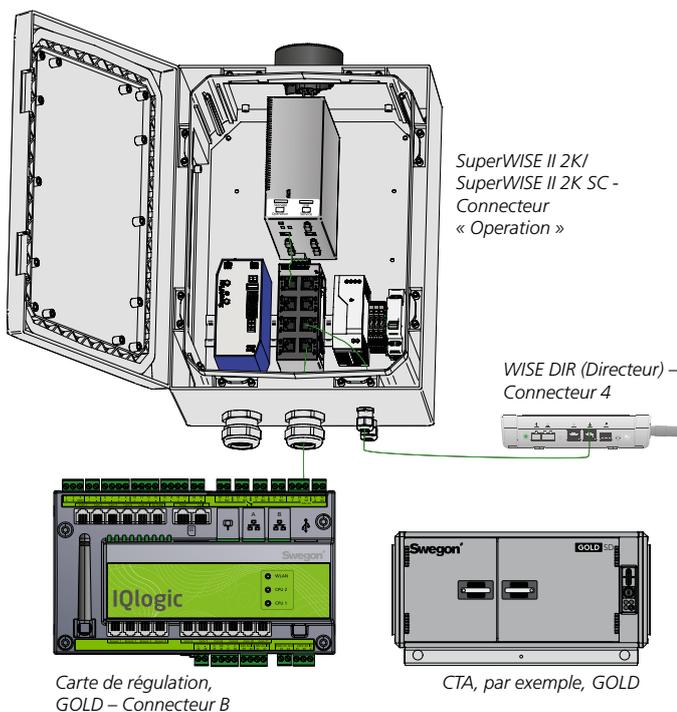
Figure 5. Connexion du réseau, SuperWISE II 2K, SuperWISE II 2K SC.
