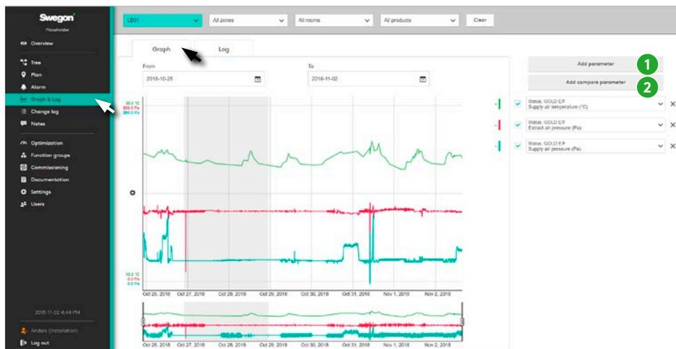
È possibile selezionare una serie di parametri da analizzare nella vista grafico direttamente nell'interfaccia di SuperWISE.
