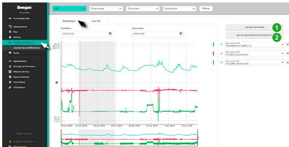
Il est possible de sélectionner ensuite une série de paramètres et de les afficher sous forme de graphique dans l'interface SuperWISE.
