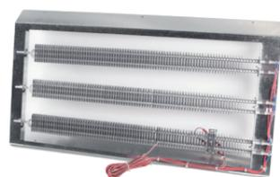
La batterie de chauffage électrique est utilisée pour réchauffer l'air soufflé et la batterie de préchauffage pour empêcher l'eau de geler dans l'échangeur de chaleur à contre-courant. Elles sont équipées de deux dispositifs de protection contre la surchauffe, l'un avec réinitialisation manuelle (110 °C) et l'autre avec réinitialisation automatique (75 °C). Toutes les connexions électriques sont protégées afin d'empêcher les personnes de les toucher.
