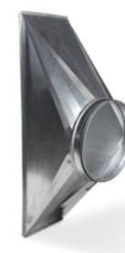
Des adaptateurs non isolés permettant la transition entre des raccords circulaires et rectangulaires, sont disponibles pour les unités et sections de post-traitement à raccords rectangulaires. Les adaptateurs sont en tôle d'acier galvanisé. Le raccord circulaire est doté d'un joint caoutchouc.
