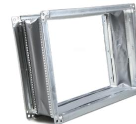
Les raccords flexibles de type MS30 empêchent les vibrations de se propager dans le circuit de gaines. Les raccords sont en plastique armé de fibre de verre ; ils ont une résistance au feu de classe M0 et une étanchéité à l'air de classe B (selon EN 15727 et EN 1751). Ils peuvent supporter des températures de service entre -30 et +110 °C et des pressions jusqu'à 2000 Pa. Le manchon de connexion « METU » de 30 mm de largeur est en tôle d'acier galvanisé d'1 mm d'épaisseur.
