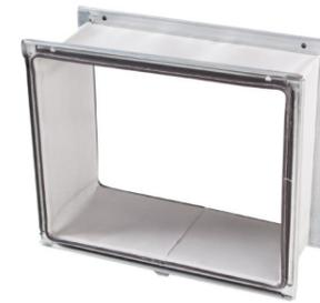
Les raccords flexibles de type MS20 empêchent les vibrations de se propager dans le circuit de gaines. Les raccords sont en plastique armé de fibre de verre ; ils ont une résistance au feu de classe M0 et une étanchéité à l'air de classe B (selon EN 15727 et EN 1751). Ils peuvent supporter des températures de service entre -30 et +110 °C et des pressions jusqu'à 2000 Pa. Le manchon de connexion de 20 mm de largeur est en tôle d'acier galvanisé d'1 mm d'épaisseur.
