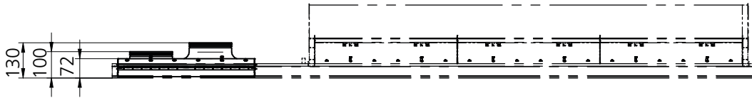
Figura 65. PACIFIC SA/EA, vista lateral y con módulo funcional en versión de conexión por la derecha
