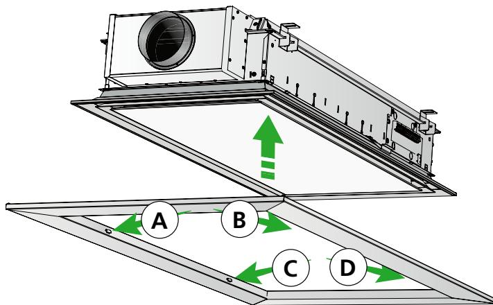
9. Pour terminer, fixer les autres extrémités au moyen des deux câbles de sécurité à insérer en diagonale dans les trous prévus à cet effet
