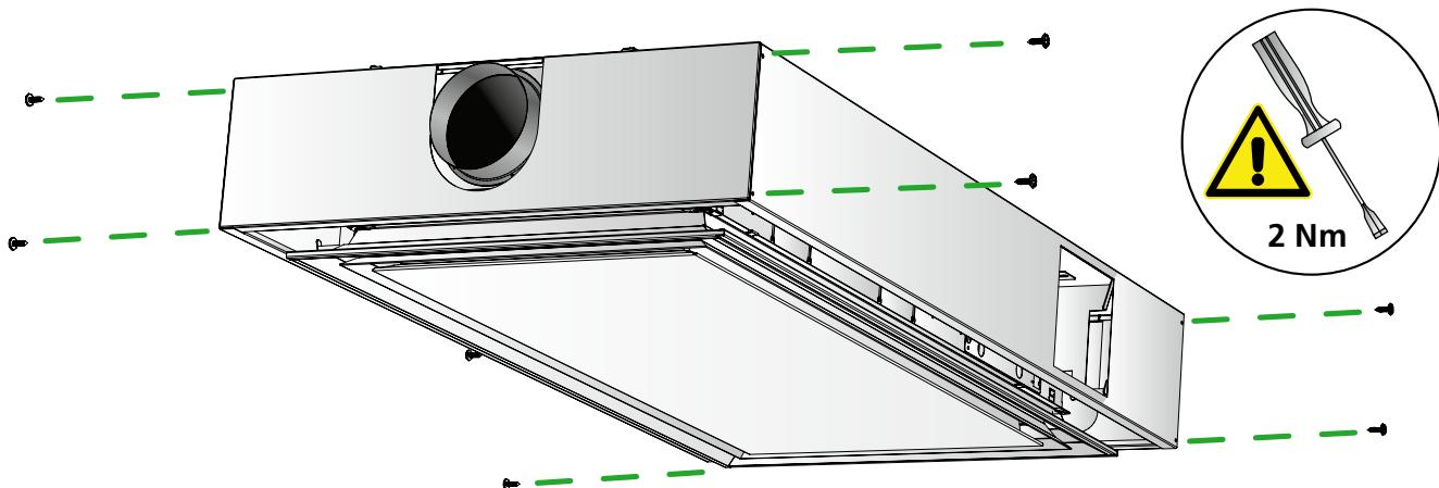
8. Installer les plaques d'étanchéité
