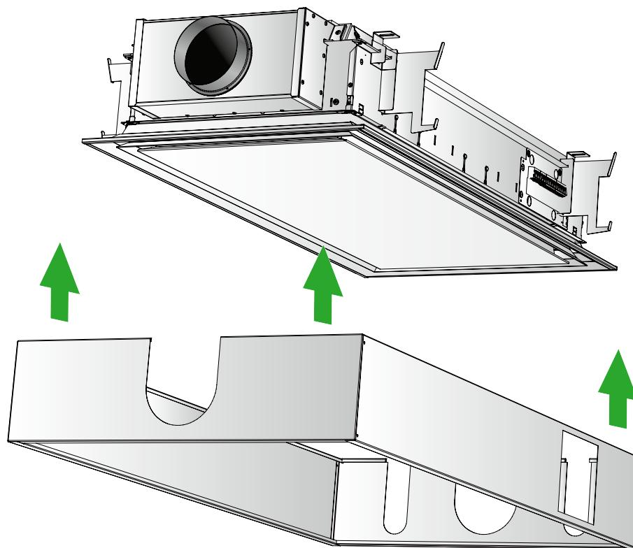
13. Installer les plaques d'étanchéité
