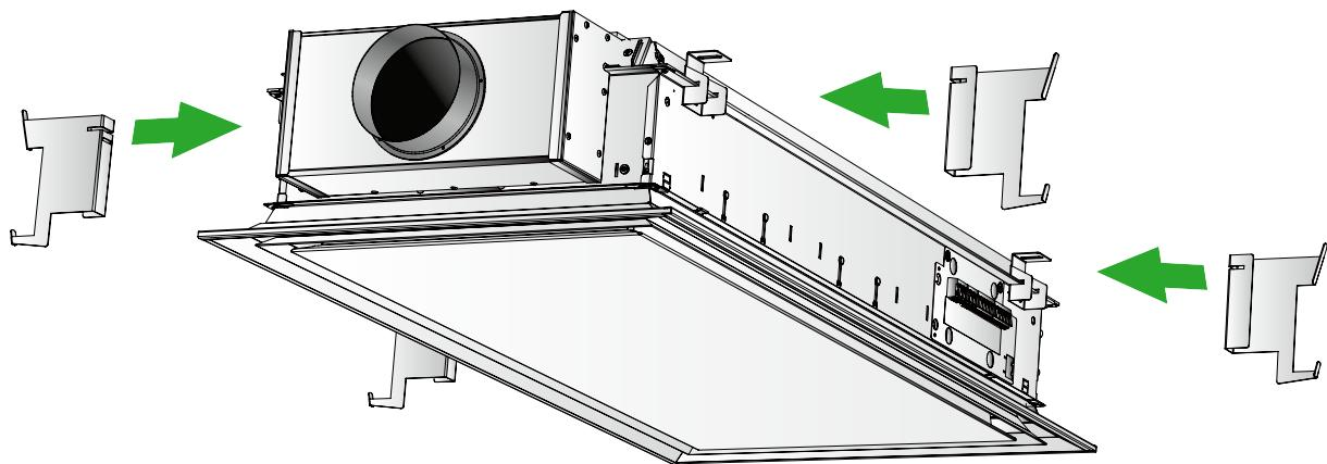
2. Fixer les quatre consoles au moyen d'une vis
