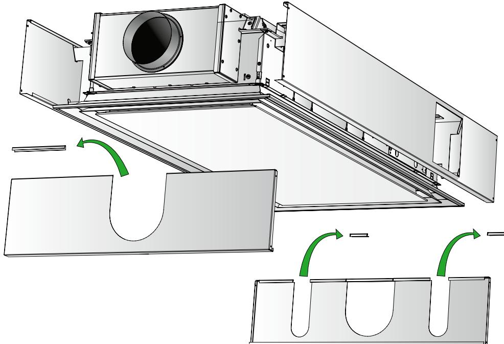
7. Assembler les côtés longs et courts avec deux vis à chaque angle. Utiliser un tournevis Phillips et serrer à 2 Nm
