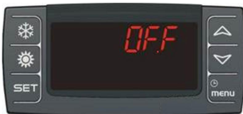
Abb. 11 Display parametrische Kontrolle mit externer Zustimmung offen
