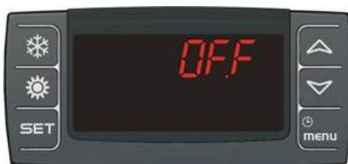
Abb. 8 Display parametrische Kontrolle mit externer Zustimmung offen
