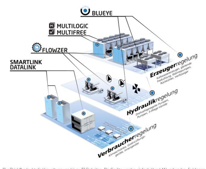
BlueThink® erlaubt die Verwaltung von bis zu 32 Einheiten. Die Geräte werden einfach über LAN verbunden. Es können mehrere Geräte mit unterschiedlicher Funktionalität und verschiedenen Installationsanforderungen verwaltet werden. Das System ist vollständig in die Steuerung eingebettet, jede Software kann in der Fabrik voreingestellt werden.
