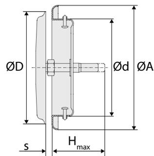
Abb. 5. TRAC, Abmessungen.
