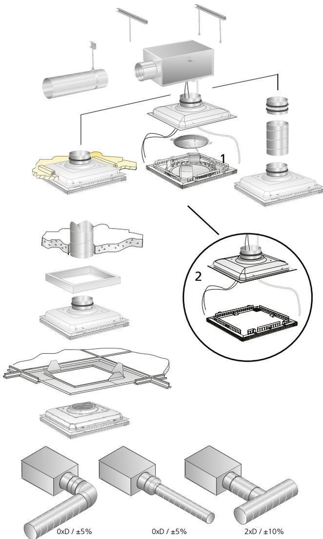
Figure 2. Installation du PELICAN pour extraction d'air.
