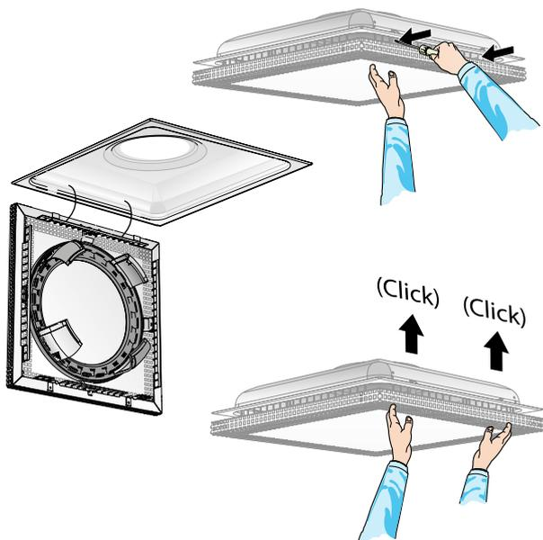
Figure 1. Quick Access, démonter la façade.
