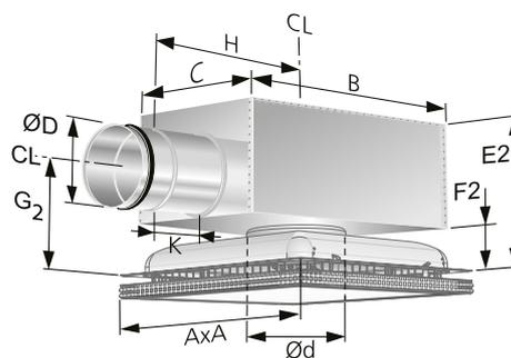
Figure 7. Dimensions, PELICAN Ceiling faible avec ALS faible.
