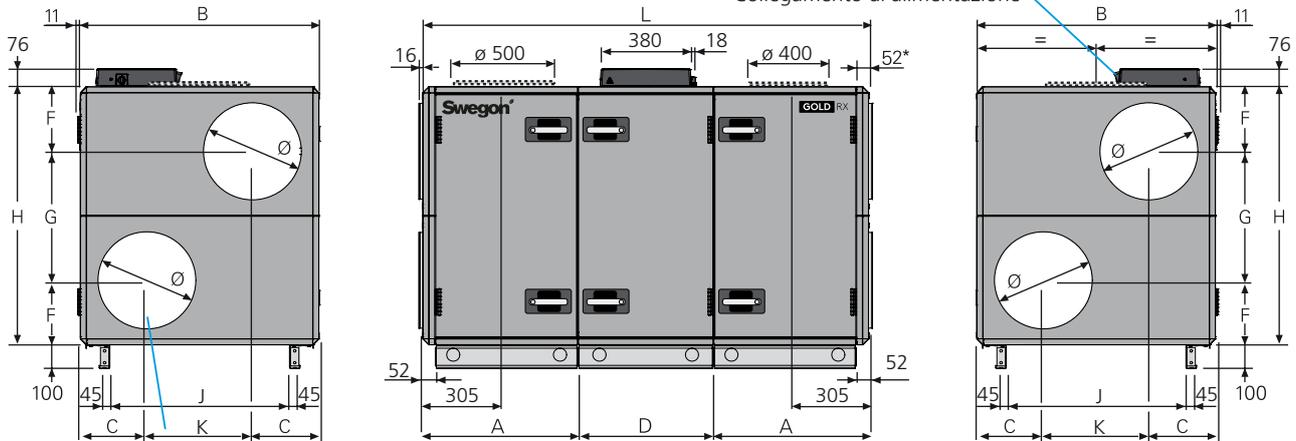
L'illustrazione mostra i collegamenti per il ventilatore dell'aria di mandata destro/livello inferiore e sinistro/livello superiore. Per il ventilatore dell'aria di mandata destro/livello superiore e sinistro/livello inferiore, i collegamenti sono invertiti specularmente.
