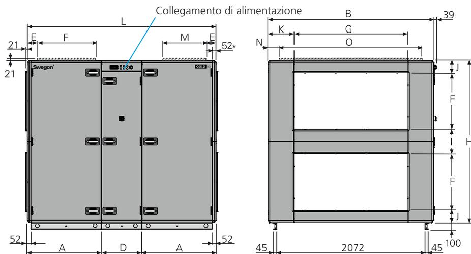
\* L'unità di trattamento aria viene fornita senza pannello di connessione terminale se verrà collegato un accessorio per canali collocato in un alloggiamento isolato. L'AHU può anche essere dotata di pannello di collegamento terminale full face (accessorio).
