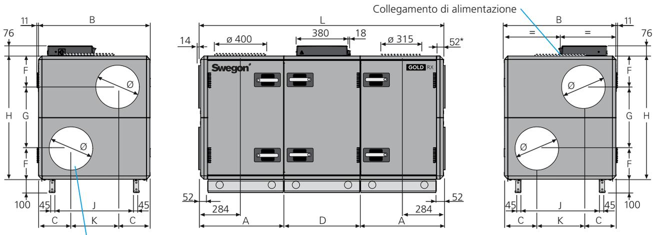
L'illustrazione mostra i collegamenti per il ventilatore dell'aria di mandata destro/livello inferiore e sinistro/livello superiore. Per il ventilatore dell'aria di mandata destro/livello superiore e sinistro/livello inferiore, i collegamenti sono invertiti specularmente.
