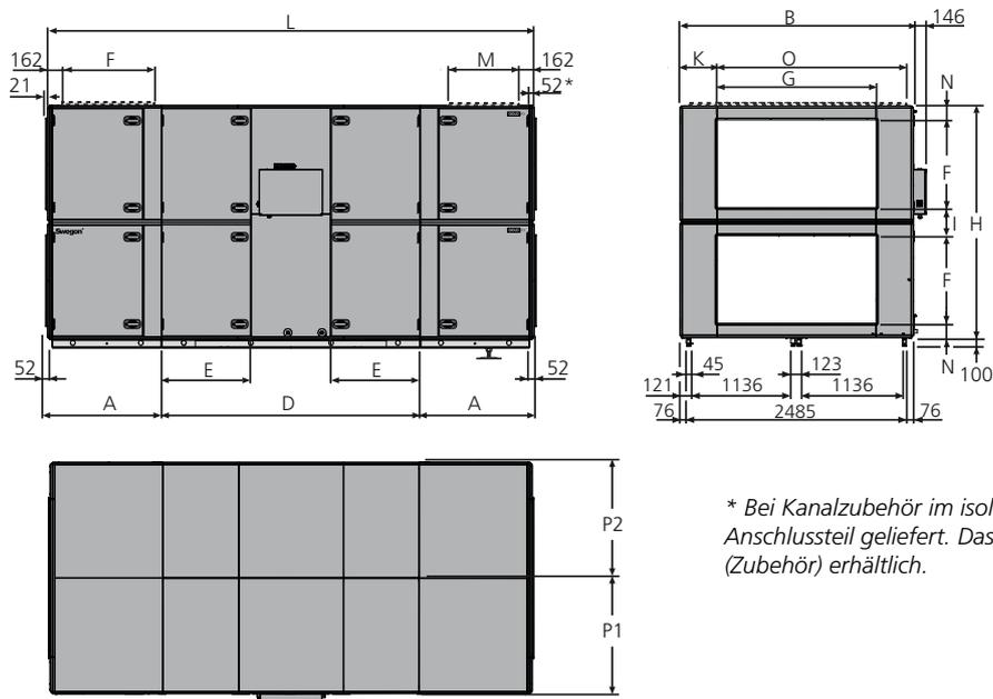
\* Bei Kanalzubehör im isolierten Gehäuse wird das Gerät ohne Anschlussstück geliefert. Das Gerät ist auch mit Full-face-Anschlussstück (Zubehör) erhältlich.
