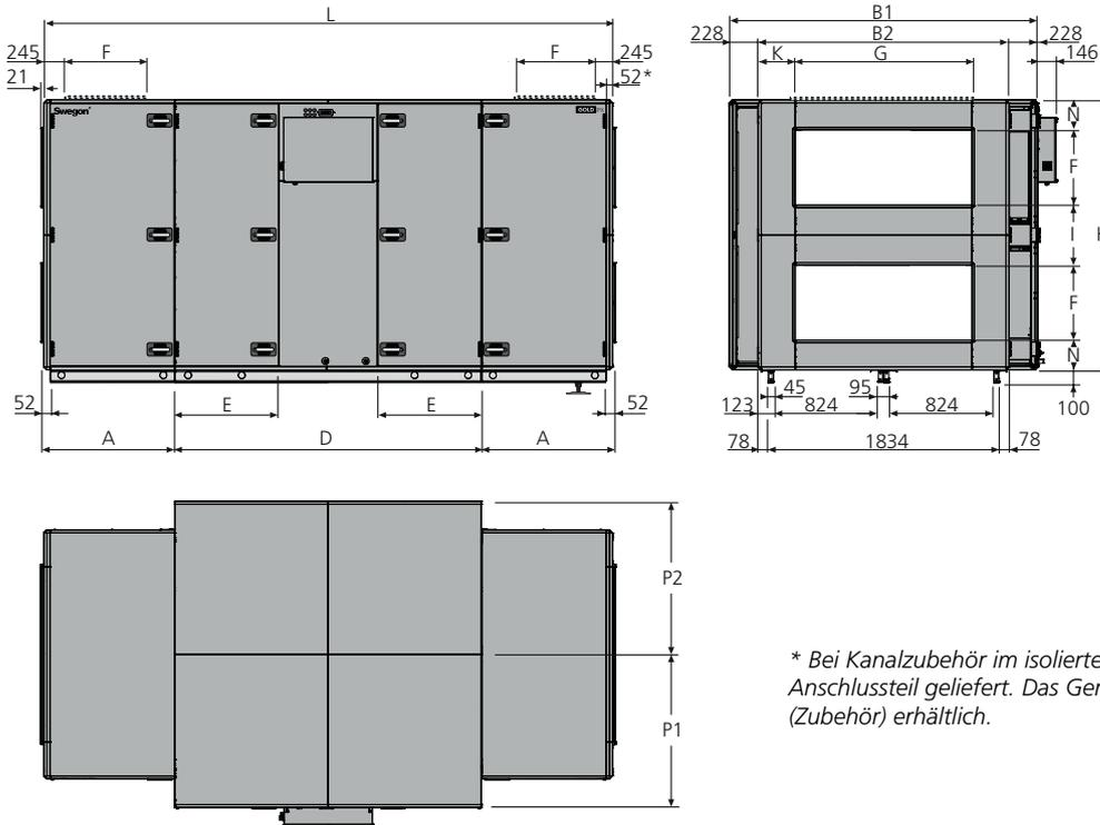
\* Bei Kanalzubehör im isolierten Gehäuse wird das Gerät ohne Anschlussstück geliefert. Das Gerät ist auch mit Full-face-Anschlussstück (Zubehör) erhältlich.
