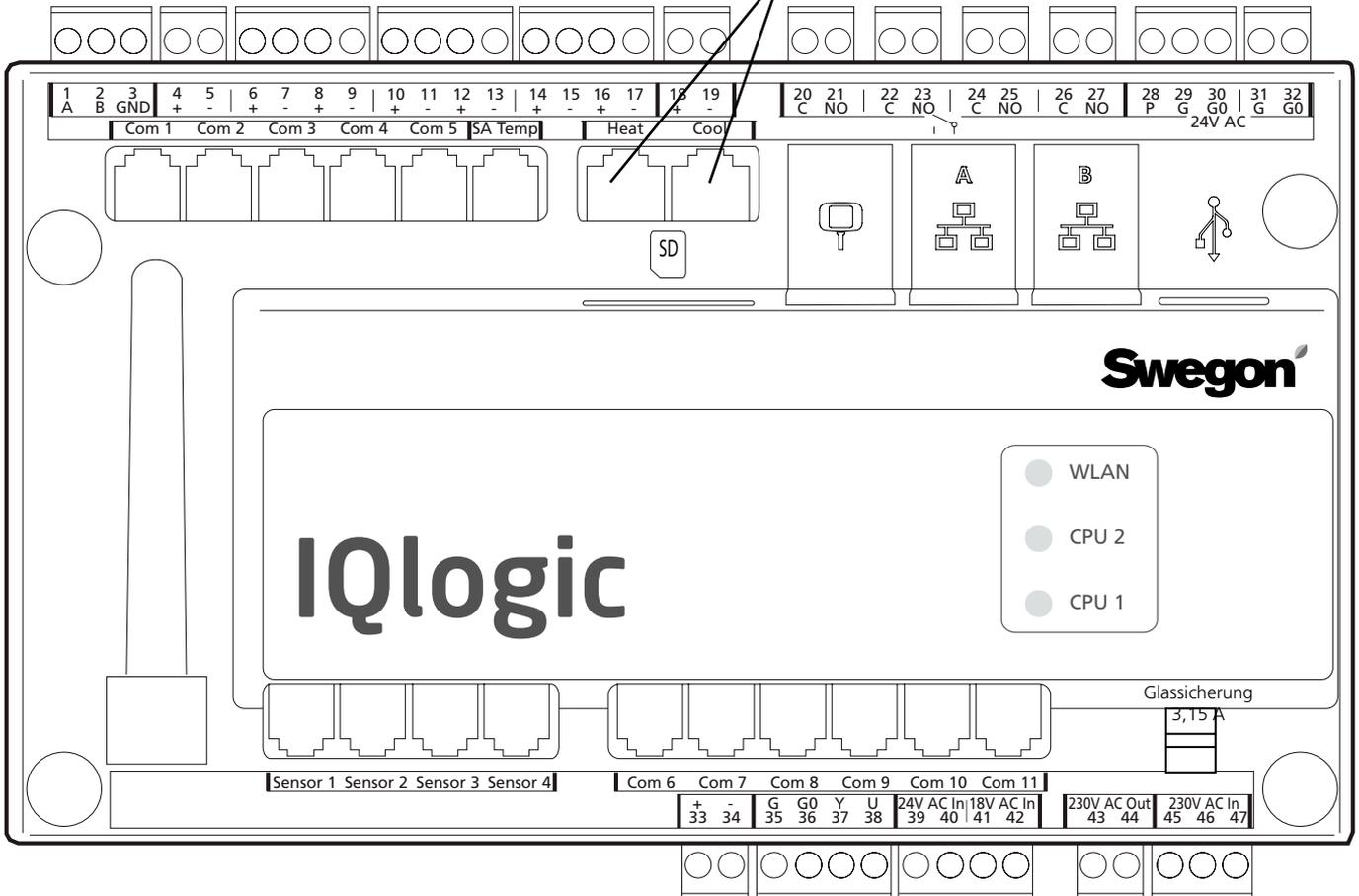
Digitale Eingänge, Anschlussklemme 4-17, Kleinspannungstyp.
