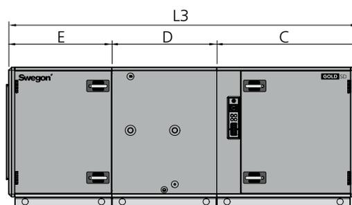
Ventilateur + filtre + échangeur à batterie
