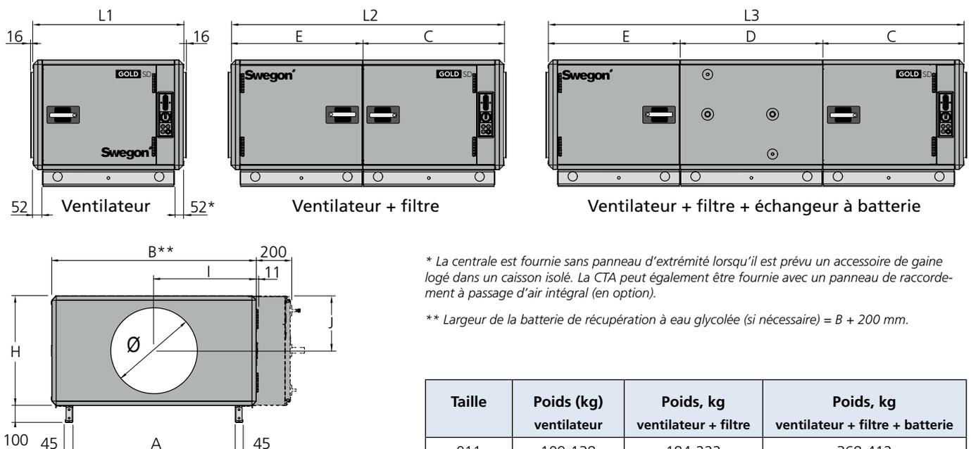
\* La centrale est fournie sans panneau d'extrémité lorsqu'il est prévu un accessoire de gaine logé dans un caisson isolé. La CTA peut également être fournie avec un panneau de raccordement à passage d'air intégral (en option).
