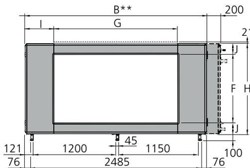
\* La CTA est fournie sans panneau d'extrémité lorsqu'un accessoire en caisson isolé est prévu; la CTA peut également être fournie avec panneau de raccordement à passage d'air intégral (en option).
