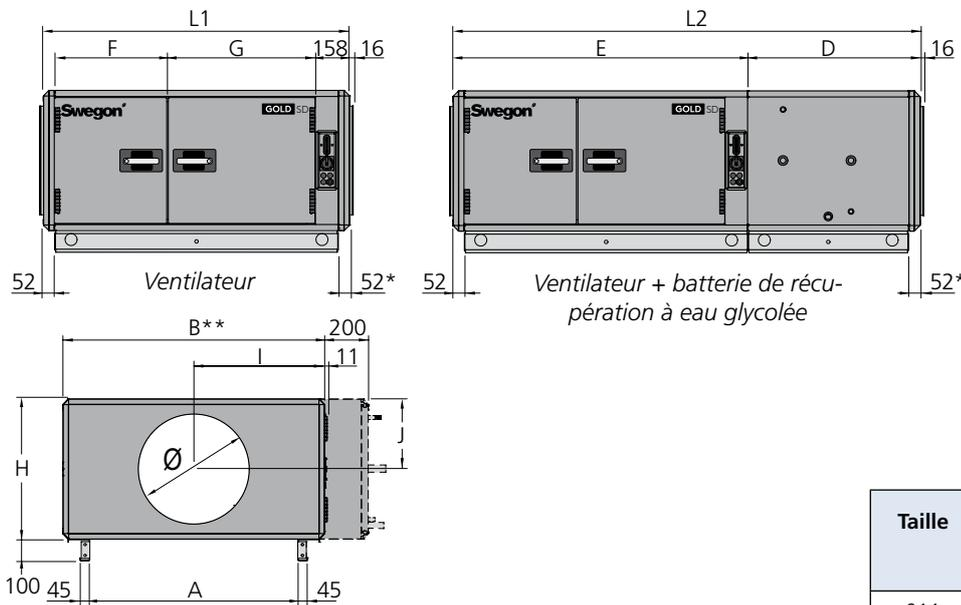
\* La centrale est fournie sans panneau d'extrémité lorsqu'il est prévu un accessoire de gaine logé dans un caisson isolé. La CTA peut également être fournie avec un panneau de raccordement à passage d'air intégral (en option).
