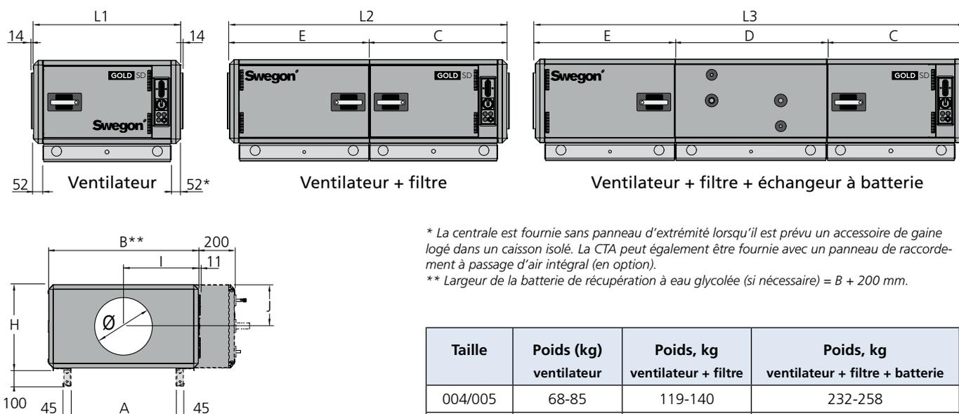
\* La centrale est fournie sans panneau d'extrémité lorsqu'il est prévu un accessoire de gaine logé dans un caisson isolé. La CTA peut également être fournie avec un panneau de raccordement à passage d'air intégral (en option).
