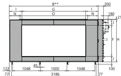
\* La CTA est fournie sans panneau d'extrémité lorsqu'un accessoire en caisson isolé est prévu; la CTA peut également être fournie avec panneau de raccordement à passage d'air intégral (en option).
