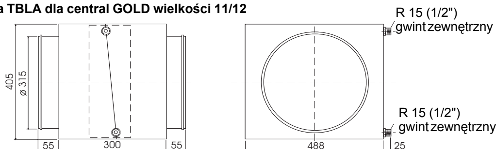
Nagrzewnica wodna TBLA dla central GOLD wielkości 11/12
