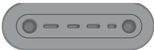
Déplacer une partie du presse-étoupe vers le côté pour pouvoir faire passer le câble de communication. Brancher le câble sur n'importe quel connecteur du module du commande. Régler la longueur de câble présente dans le compartiment électrique et ajuster le presse-étoupe avant de le remettre correctement en place.
