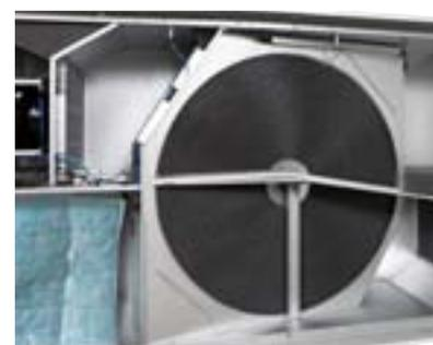
L'échangeur de chaleur rotatif RE-CONOMIC est installé en biais, offrant une plus grande surface de contact et, par conséquent, une excellente récupération de chaleur avec des pertes de charge réduites.
