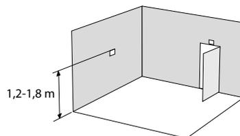
Figure 2. Emplacement recommandé de la sonde WISE OCS.
