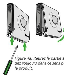
Figure 4a. Retirez la partie avant. Procédez toujours dans ce sens pour démonter le produit.
